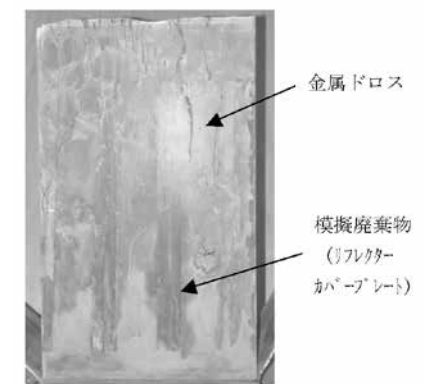
写真10 硬化後の脱型面
