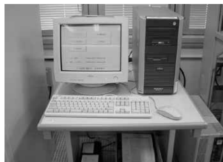
写真2 データ伝送処理装置 (送信側)
