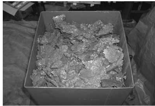
写真6 充てん後の容器上部の状況 (上部は均し効果によりほぼ平ら)
