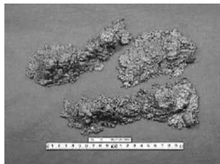
写真1 塊状ドロスの例
