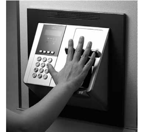
図4 手のひら静脈認証入室装置
