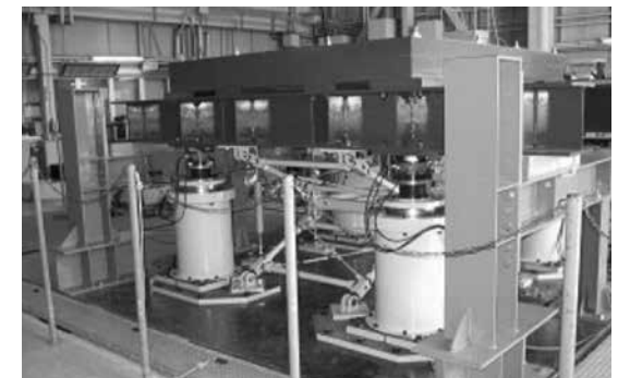
写真1 空気ばね単独の振動台試験
