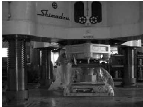
写真2 空気ばねの耐圧試験
