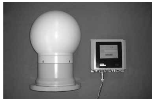
図4 n線エリアモニタ (左：センサ部 右：計測部)
