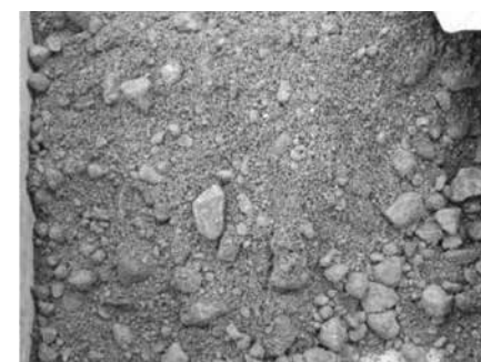
写真1 解体コンクリート塊の外観
