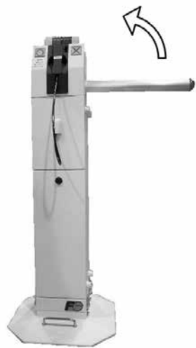
写真5 線量計携帯確認装置
