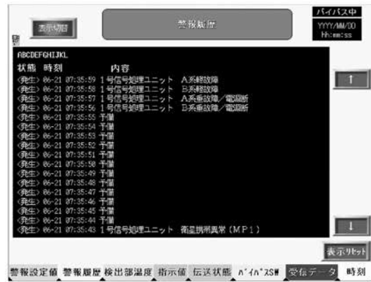
図4 操作表示パネルの警報履歴画面
