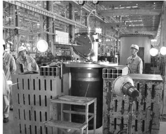
図2 モックアップの耐圧試験
