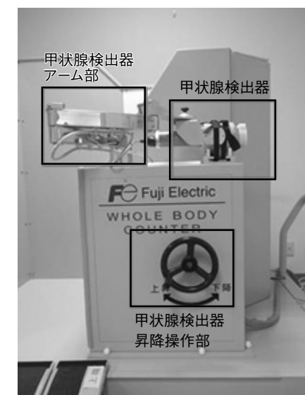
写真3 甲状腺用検出器構造
