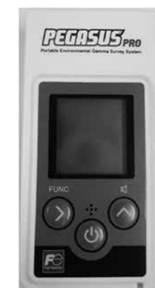
写真6 携帯型環境測定用線量計
