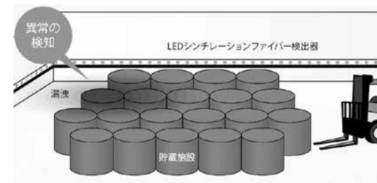
図10 貯蔵施設などにおける放射性物質漏洩の検知イメージ
