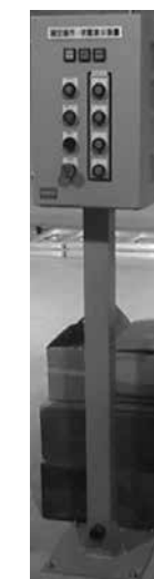
写真2 測定操作・状態表示装置
