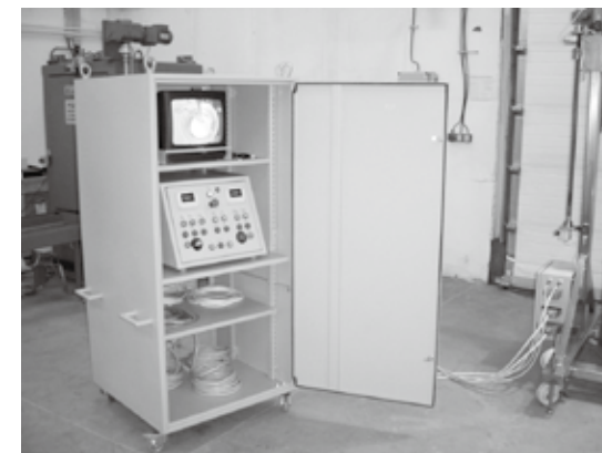
図2 インドラムミキシング装置と制御装置例
