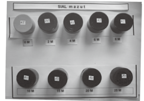
図4 ブラックオイル固化サンプル(充填率0~25w%)
